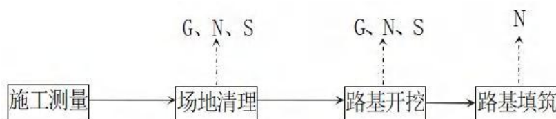
图 3.3-1 路基施工工艺流程图
